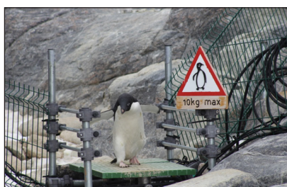
Passerelle d'identification et de pesée automatique
